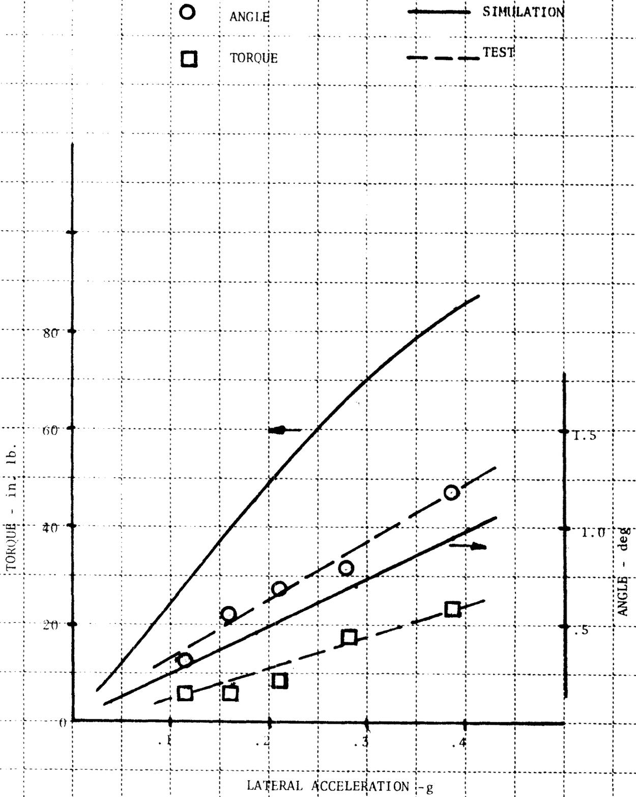
FIGURE 51: DIRECTIONAL CONTROL TEST COMPARISON
