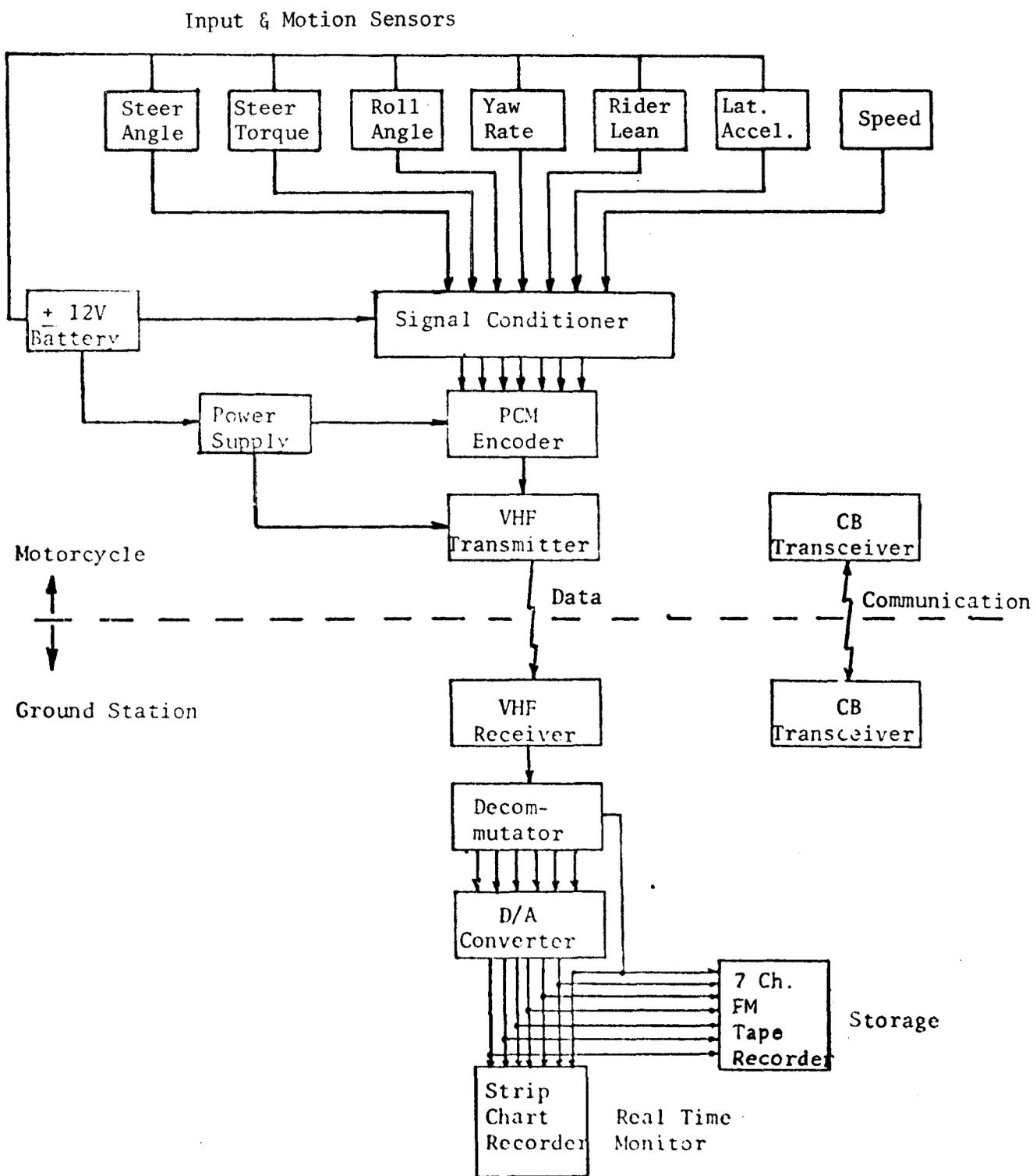
Figure 8. MOTORCYCLE DATA ACQUISITION SYSTEM
