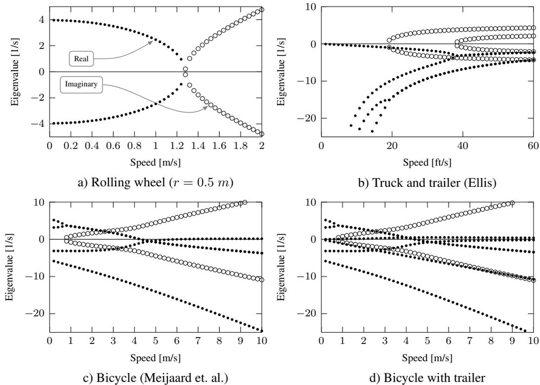
**Figure 1.** Eigenvalues vs. speed
